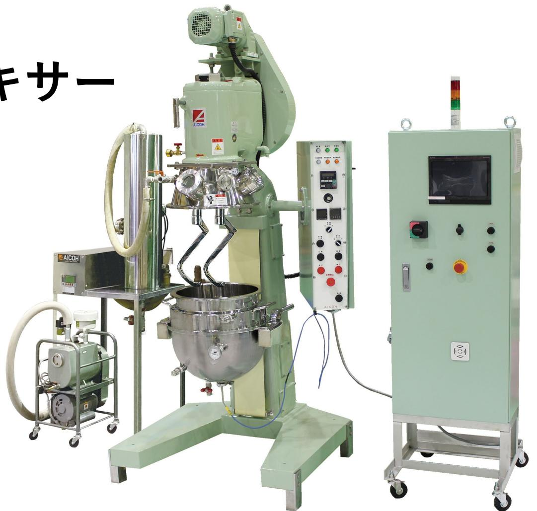
ミキサー本体だけでなく、ポンプや溶剤回収装置等の付帯設備も新型の制御盤で一括操作が可能で、省力化・省人化にも役立ちます。
